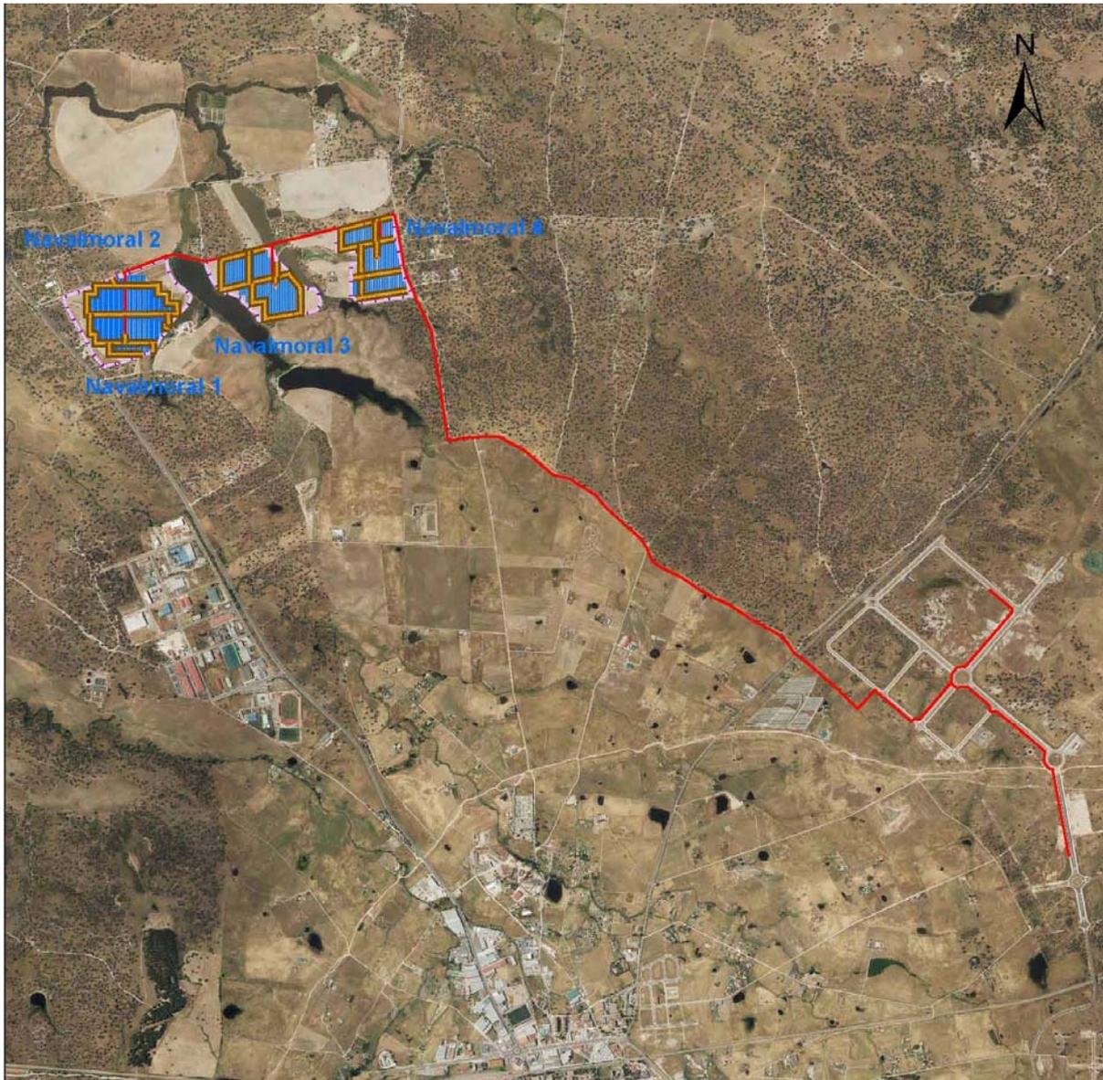
Imagen 1: Implantación definitiva para instalación de las 4 PSFV (entre ellas PSFV Navalmoral 1) y su sistema de evacuación
